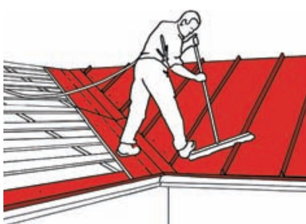
Закрепите листы кровельного покрытия, уложенные по ендовой, с помощью саморезов. Каждый лист закрепите с помощью двух саморезов, расположенных ровно на одну треть длины листа от каждого края.
