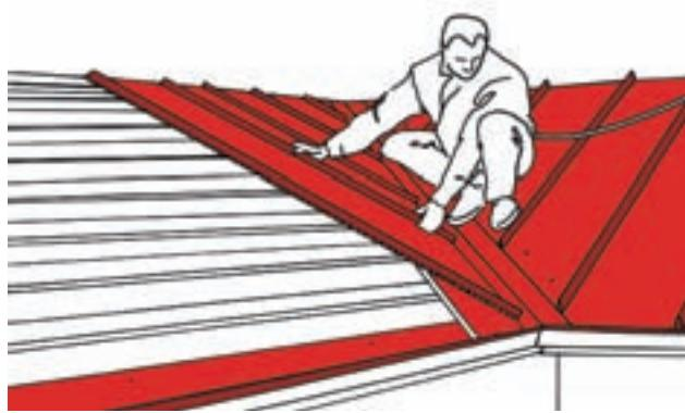
Измерьте, вырежьте и уложите оставшиеся листы кровельного покрытия по ендove. Соответствие листа шаблону можно проверить с помощью ориентиров, начертенных на обрешетке, или за счет измерения расстояния между следующим для монтажа листом и опорным листом. Также следите за углом ендовой и подгоняйте его при необходимости с помощью треугольного шаблона.
