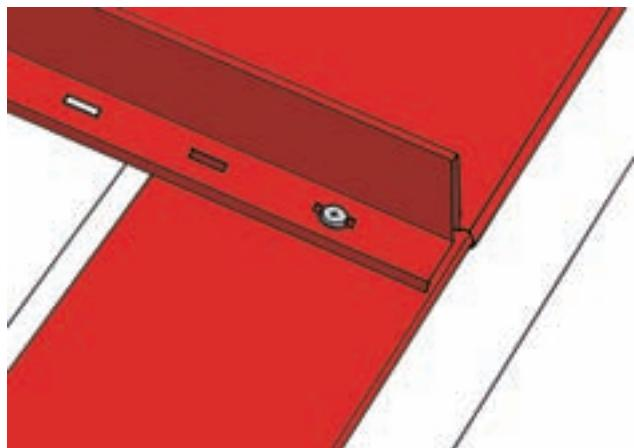
Закрепите лист приблизительно в середине отверстия. Саморезы, проходящие через накладку карниза, закрепляют накладку на своем месте. Будьте внимательны с силой затяжки и направлением закручивания саморезов. Слишком сильно затянутые саморезы будут препятствовать тепловому расширению. Если саморез закручивать под углом, то лист кровельного покрытия, расположенный поверх замочной части, не будет закреплен до низа стыка.
