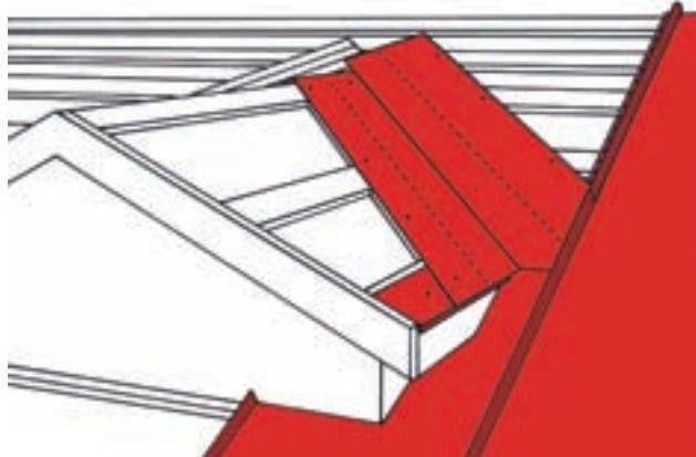
Прижмите слой уплотнителя к листу кровельного покрытия, чтобы угловой лист ендовы закрывал его. Сначала закрепите лист ендовы с помощью саморезов. Прижмите вертикальную кромку листа кровельного покрытия на расстоянии нахлеста. Более подробную информацию по монтажу внахлест можно найти в разделе Наращивание листов кровельного покрытия (стр.13).
