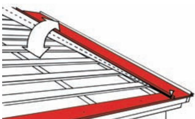
Сторона С подгоняется под размер за счет поворота листа металличерепицы вокруг точки фиксации. Как только расстояние будет равно 5 метрам, значит, лист уложен под прямым углом к карнизной планке. Закрепите лист вдоль замочной части к каждой доске обрешетки.
