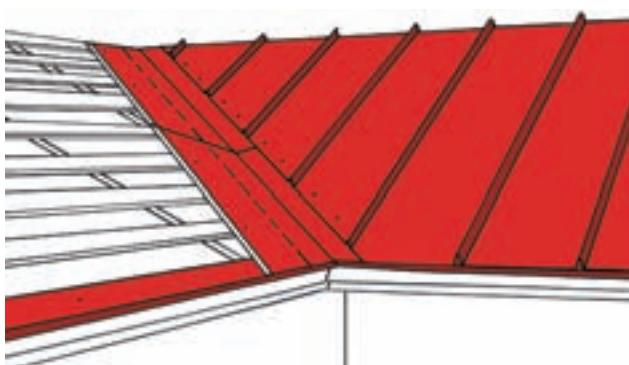
Смонтируйте обрезанные листы кровельного покрытия до верха ендовой. Рекомендуется наносить герметик под нахлести листов кровельного покрытия на ендовой. В процессе монтажа следите, чтобы угол ендовой совпадал с линией ориентира. При необходимости скорректируйте форму треугольного шаблона.
