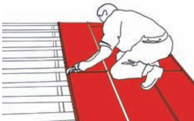
Осторожно зажмите обе кромки с помощью пассатижей. Закрепите лист. Удалите защитную пленку с кромки.
