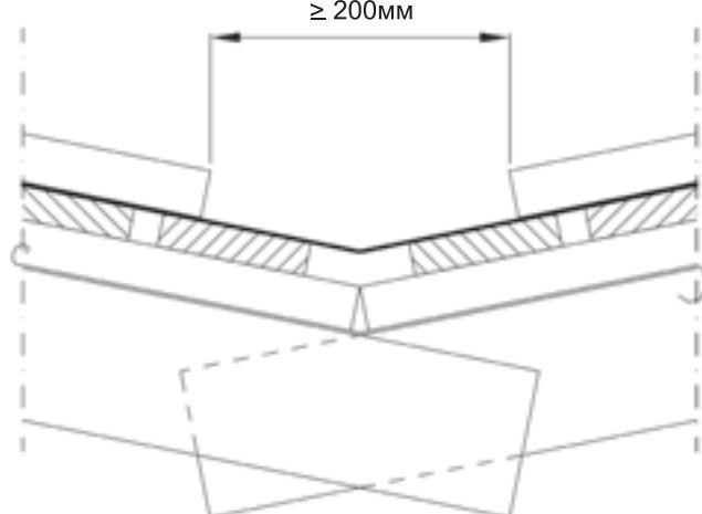
Минимальное расстояние между линиями (указывающими на место расположения листов кровельного покрытия) должно составлять 200 мм. Угловой лист ендовы должен заходить под лист кровельного покрытия минимум на 250 мм.
