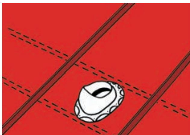
Прижмите верхнюю насадку на место. Закрепите верхнюю насадку к листу кровельного покрытия с помощью саморезов из комплекта поставки вентиляции.
