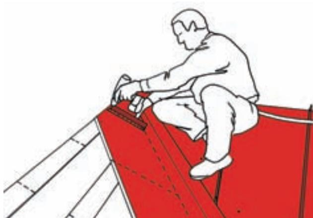
Проверьте, чтобы угол треугольного шаблона был именно такой, какой необходим. Отрежьте первый лист кровельного покрытия необходимого размера и под необходимым углом. Закрепите лист у конька с помощью одного самореза.
