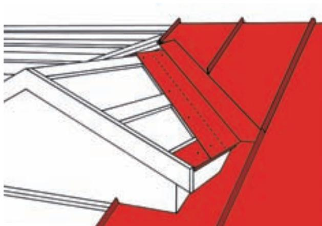
Смонтируйте листы кровельного покрытия до конька слухового окна. Последний лист не следует закреплять, необходимо просто прижать на месте по кромке. Лист не следует закреплять прежде, чем будет установлен другой лист ендовы слухового окна.
