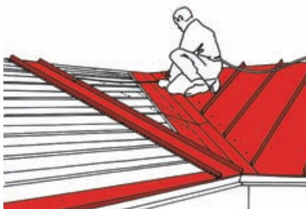
Отмерьте и начертите расположение листов кровельного покрытия до конька. Будьте внимательны: первый лист кровельного покрытия должен быть уложен от ориентира, начертенного на листе ендовы.
