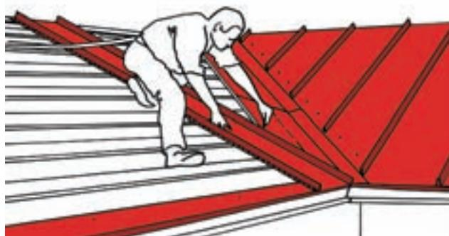
Смонтируйте лист кровельного покрытия в качестве опоры в углу ендовы. Подгоните опорный лист кровельного покрытия к прямому углу. Более подробную информацию по подгонке опорного листа можно найти в разделе Монтаж кровли (стр.6). Закрепите опорный лист к обрешетке с помощью некоторого количества саморезов. Начертите ориентир на обрешетке вдоль края опорного листа.
