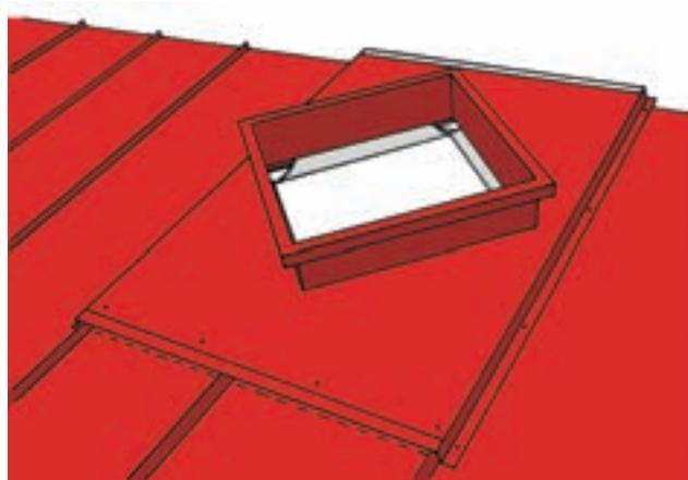
Примостите люк на место и закрепите стороны к листу кровельного покрытия с помощью саморезов (4 самореза/сторона). Закрепите верх и низ пожарного люка к опорной накладке с помощью саморезов (4 самореза с каждого края).
