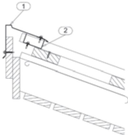
**Односкатная кровля, вертикальный разрез**
