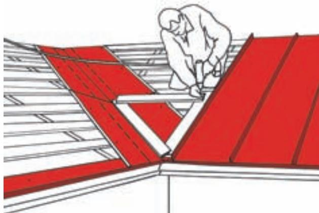
Смонтируйте листы кровельного покрытия до ендовой. Угол среза листов, которые будут уложены по ендовой, можно определить, например, с помощью треугольного шаблона.
