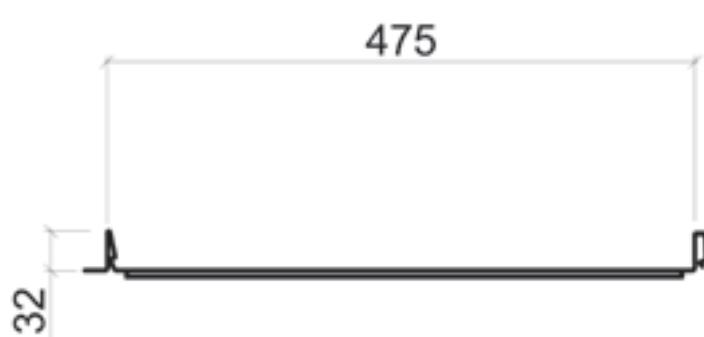
Поперечный разрез модели Classic C
