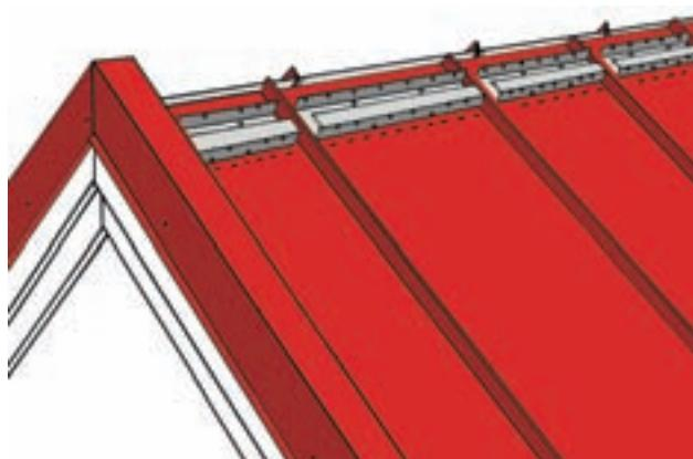
Точку крепежа вентиляционной накладки конька можно определить путем приладки коньковой накладки на место. Отметьте край коньковой накладки на листе кровельного покрытия. Вентиляционную накладку конька следует монтировать не по линии, а отступив 20 мм от нее по направлению к коньку. Вентиляционная накладка конька крепится к листу кровельного покрытия с помощью двух саморезов (Внимание: не к обрешетке).
