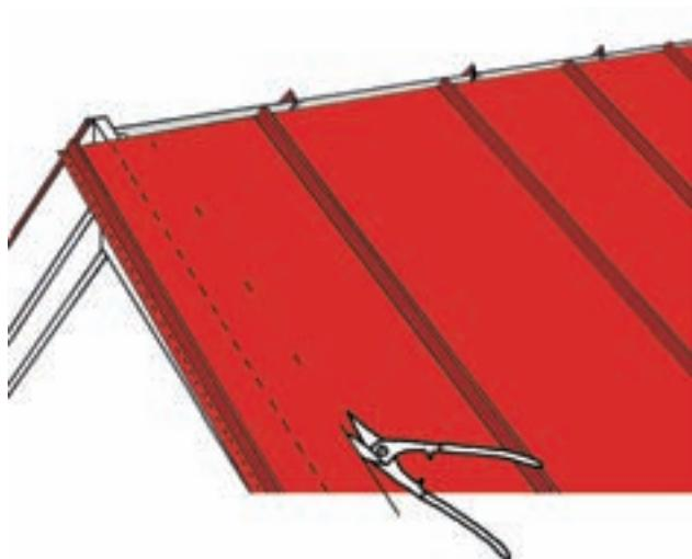
Начертите линию свеса кровли на том листе, который выступает за край. Отрежьте лист не по намеченной линии, а отступив на 50 мм от линии в направлении поверхности кровли.
