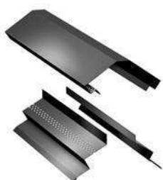
**Плоская коньковая планка Ruukki® Nyugge** состоит из трех элементов. Каждый из них имеет перфорацию для эффективной вентиляции конструкции кровли. Специально разработанная форма скрывает крепежные элементы.
