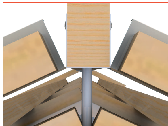
14. Схема размещения подконькового бруса
